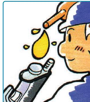
Dare alla macchina l'appropriata lubrificazione, la lubrificazione è indispensabile per i motori ad aria durante e dopo il funzionamento dell'utensile immettere qualche goccia di olio (olio idraulico VG10) nello stesso attraverso la presa d'aria sul corpo della macchina. Applicare periodicamente del grasso (a base di litio) sui battenti, ingranaggi e cuscinetti.
